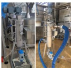
Sono in corso decine di prove nei caseifici di tutte le zone d'Italia per dimostrare nella realtà l'elevato livello di filtrazione delle nostre macchine che, grazie alle maglie in acciaio inox forate a laser, filtrano liquidi a bassa ed alta viscosità da 30 a 2.000 um.
